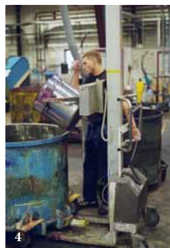
4. De „heavyduty” PRO200 met „Easy-Squeeze” klemsysteem en manueel draaisysteem.
