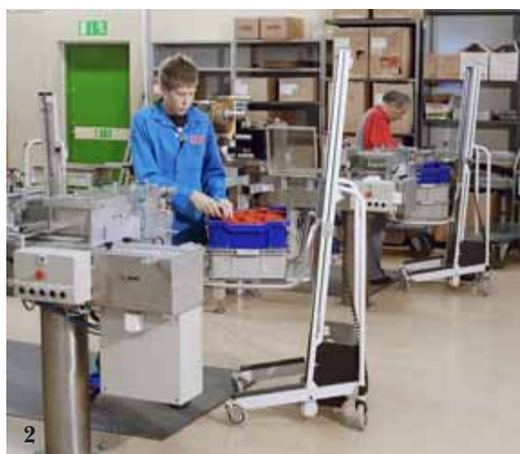
2. Deze PRO100's worden ingezet als mobiele werkstations in de assemblage lijn.
