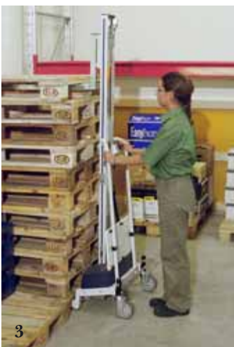
3. De PRO70SB met uitschuifbare vorken voor het stapelen van lege pallets. Een afneembaar platform kan bovendien dozen tillen.
