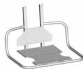
8522 Platform voor PRO100, 695x520 mm. Aluminium traanplaat. 8522SS RVS uitvoering met glad oppervlak. Bereikt vloerniveau.
