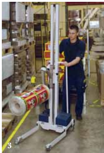
3-4. Een kantelbare doorn grijpt de binnenkant en draait de rol van een verticale stand naar een horizontale positie. PRO70 (links) PRO120 (rechts).
